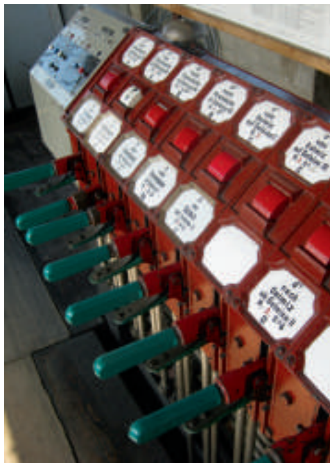
Der Rollenblock mit den acht Fahrstrassenhebeln. Der Pfeil im zweiten Feld von links zeigt an, dass die dazugehörige Fahrstrasse zur Einstellung freigegeben ist; der Befehl erfolgt durch Kurbeldrehung des Fahrdienstleiters. Die übrigen Hebel sind in der Grundstellung (Pfeilfeld mit roter Klappe abgedeckt).
